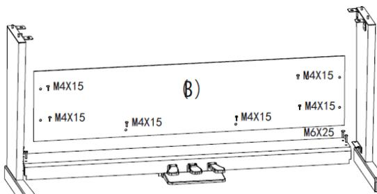
2. Fije el tablero lateral (A) y tablero trasero (B) / pedal(C) con 6 tornillos (E)
