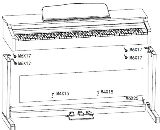
Coloque el piano en el tablero lateral (A), fije el piano y el soporte con 4 tornillos de plástico (F)
