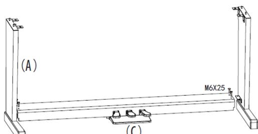
1. Fije la tabla lateral (A) y la tabla de pedales (C) con 4 tornillos (D) M 6 x 25
