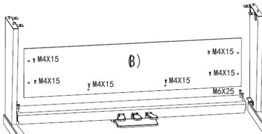
2. Fixar a tábua lateral (A) e placa traseira (B) / pedal (C) com 6 Parafusos (E)
