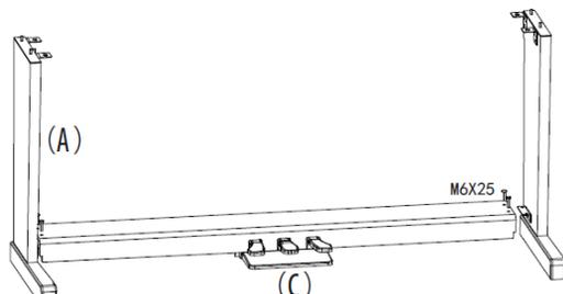
1. Fixar a placa lateral (A) e a placa de Pedal (C) com 4 Parafusos (D) M 6 x 25
